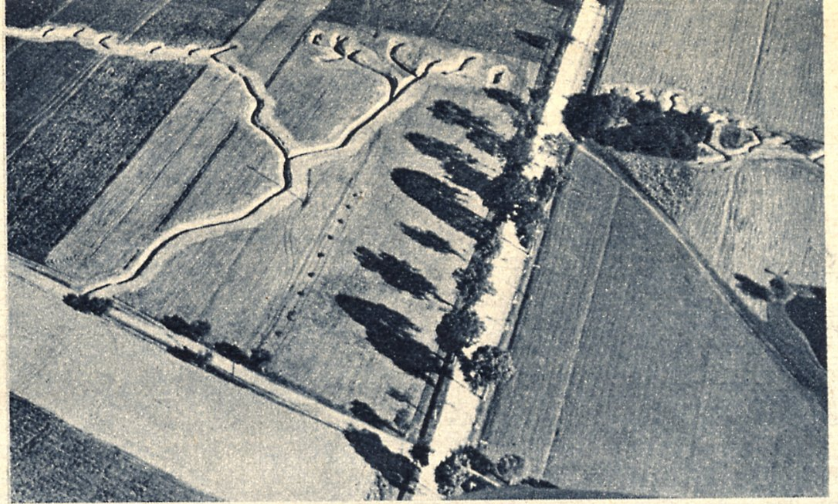
Eine polnische Feldstellung läßt deutlich die vom Hauptgraben abzweigenden Schützenlöcher und MG-Stände erkennen, mit denen die Polen den deutschen Vormarsch aufhalten wollten
