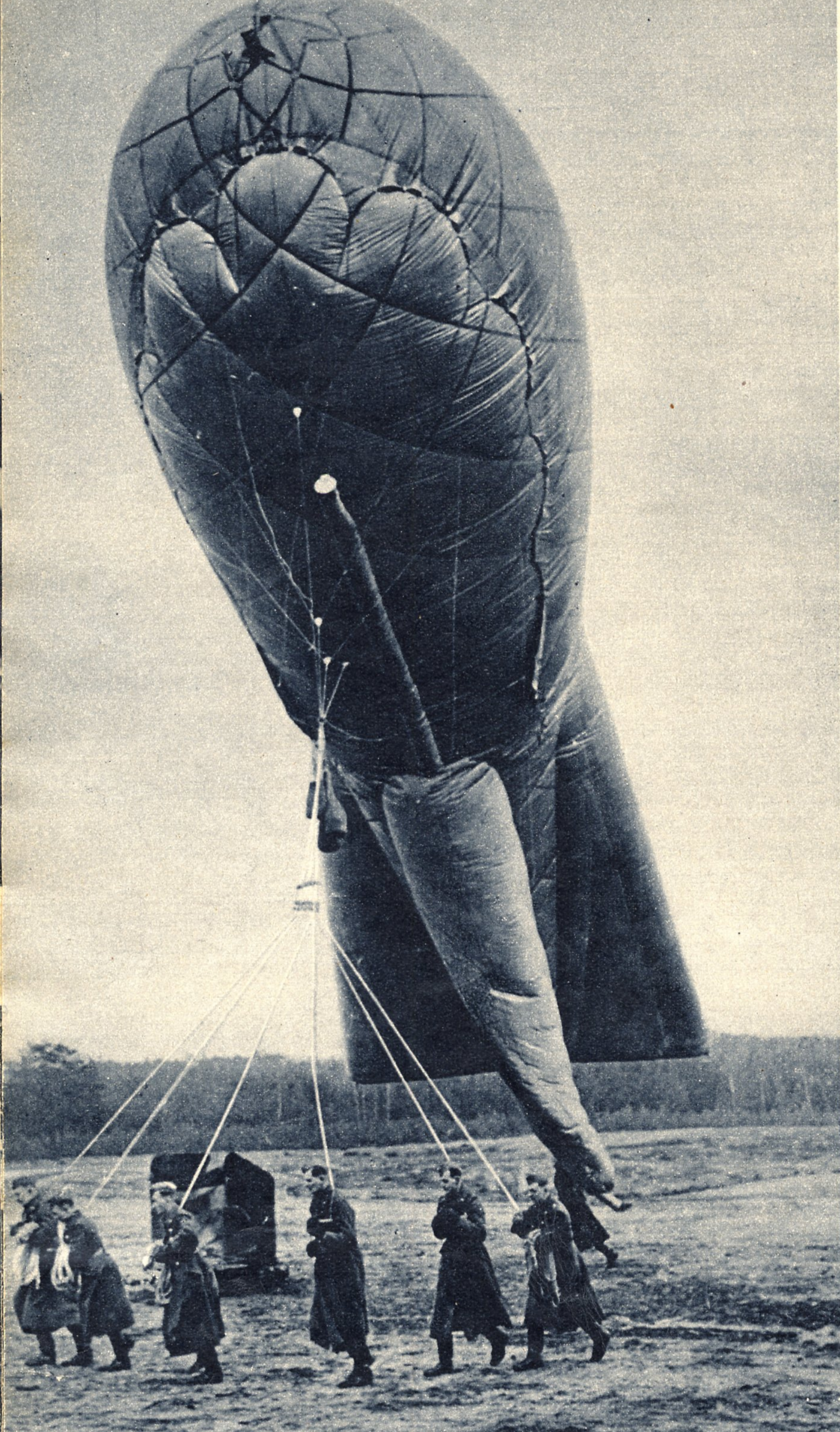
Mannschaften der Ballonsperrabteilung transportieren einen Sperrballon, um ihn an Ort und Stelle mit der Ballonwinde hochzulassen Aufn. Scherl
